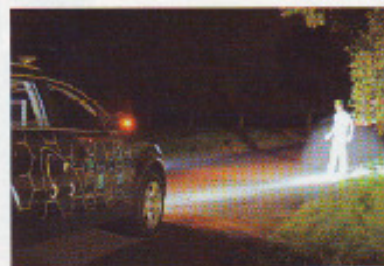
Frühwarnsystem: Ein LED-Scheinwerfer strahlt entfernte Hindernisse an.
